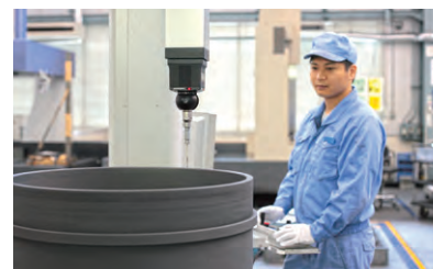
三次元測定機による検査
