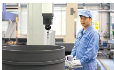
三次元測定機による検査
